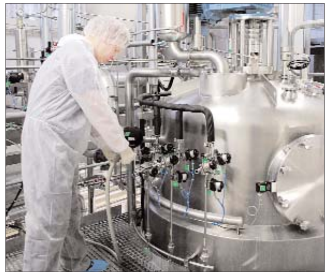
Produktionsfermenter für die Herstellung von Bacillus subtilis .
