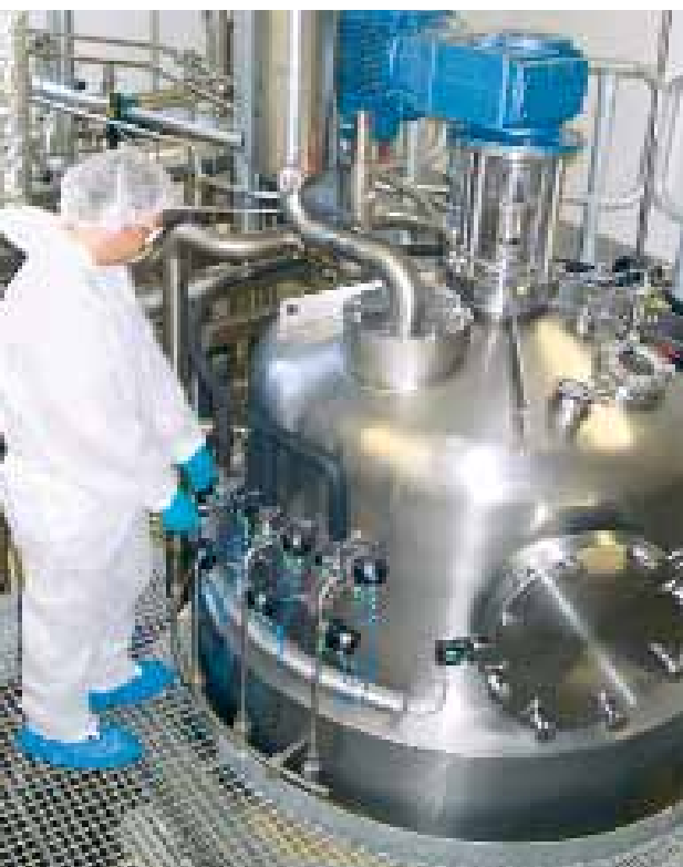
Produktionsfermenter für die Kultivierung von Mikroorganismen.
